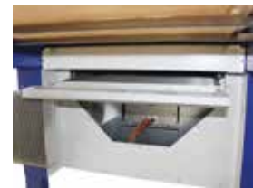
schnell und einfach austauschbarer Luftfilter
